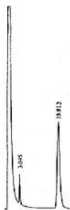
图A 标准品气相色谱图 图中 tr=0.588 溶剂， tr=3.045 大蒜辣素 tr=11.011 大蒜素
